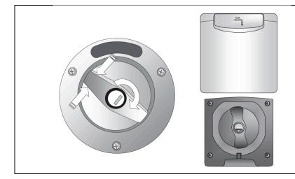
Pour l'ouverture et la fermeture du bouchon avec la clé, il faut maintenir le bouchon dans sa position afin d'éviter une rotation lorsque vous tournez la clé dans la serrure.
